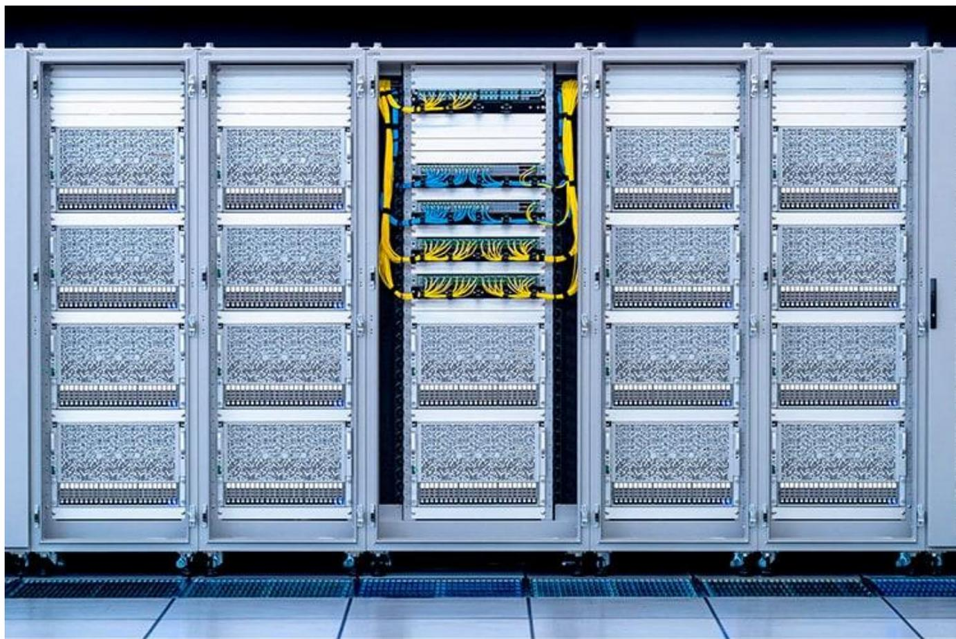
[図 8] Preferred Networks 社が神戸大学と共同開発した、超低消費電力の深層学習用プロセッサ (MN-Core) を用いた計算機 (MN-3)。
