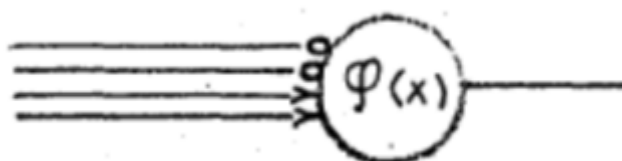
図 1 フォン・ノイマン氏が 1952 年の講演で示したオートマタ (Automata) を合成するための部品の基本モデル このモデルを、基本器官 (Basic organ)、もしくは、単出力オートマトン (Automaton) と呼ん
